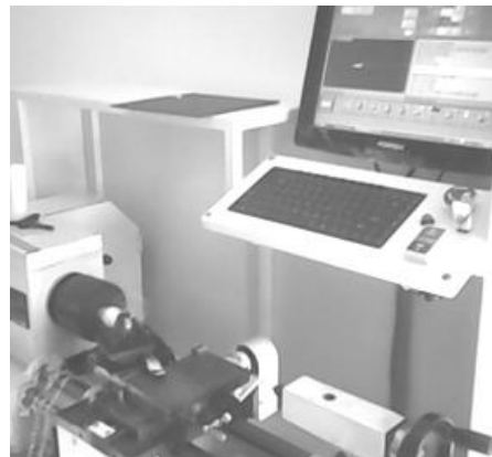
Gambar 4.12Proses pemakanan pahat pada benda kerja mesin CNC bubut.
