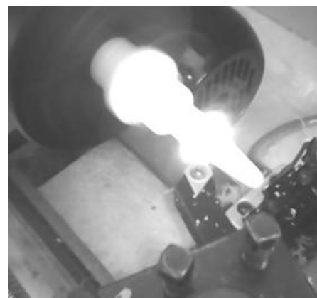
Gambar 4.13Proses pemakanan pahat pada benda kerja ( finishing ) mesin CNC bubut.
