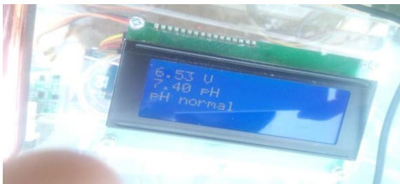
Gambar 3.26 sensor pH alat di tambak pada LCD
