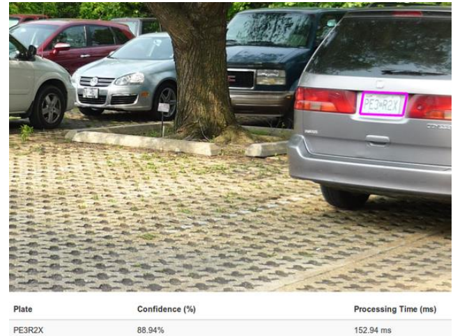
Gambar 1. Teknik OpenALPR mendeteksi plat nomor
