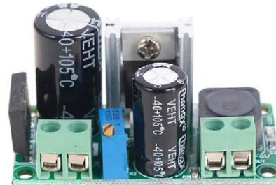
Gambar 2.4 Rectifier dan Filter
