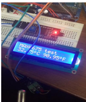
Gambar 3. Uji coba sensor Termokopel dengan menggunakan IC MAX6675
