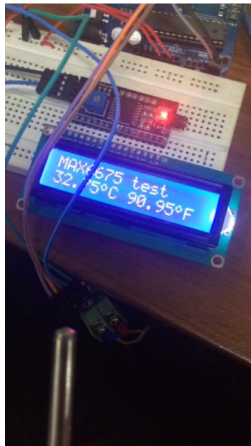
Gambar 3. Uji coba sensor Termokopel dengan menggunakan IC MAX6675
