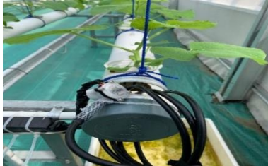
Gambar 4. Sensor Suhu, pH, Kelembapan dan ppm Air Nutrisi
