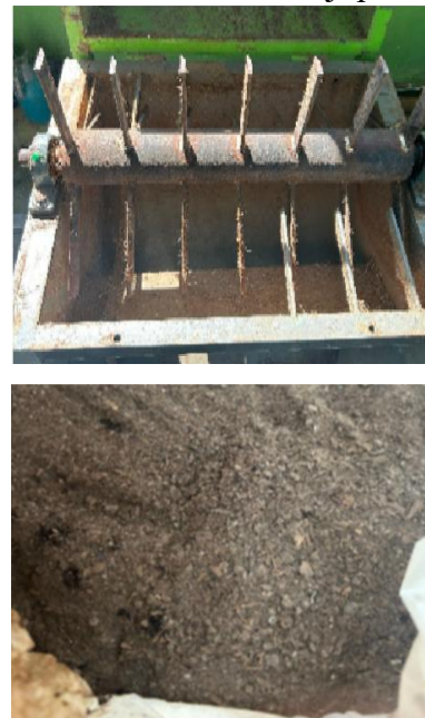
Gambar 5. Alat Pencacah yang Telah Diperbaiki dan Pembuatan Kompos
