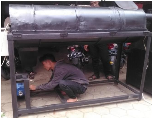
Gambar 3. Perakitan Mesin Pengering Kopi
