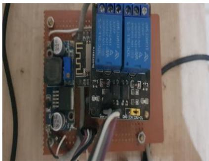
**Gambar 8. Penerapan letak modul relay 2 channel, Nodemcu esp8266, dan step down dc 12v**
