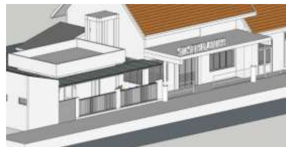
Gambar 4. 7 Pagar pembatas peron
