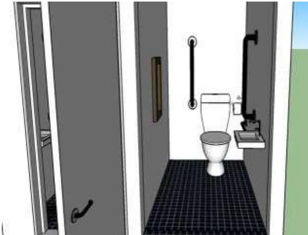
Redesain pada toilet disabilitas ini menyesuaikan standart ukuran panjang 227,5 cm lebar 152,5 cm, lebar pintu 90 cm dan juga penambahan handrail guna mempermudah bagi penyandang disabilitas dalam menggunakan toilet, handrail juga berfungsi untuk mempermudah rambatan serta pegangan untuk keselamatan.
